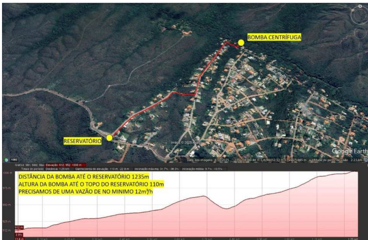
Figura 10 - Linha de recalque da quadra 14.
